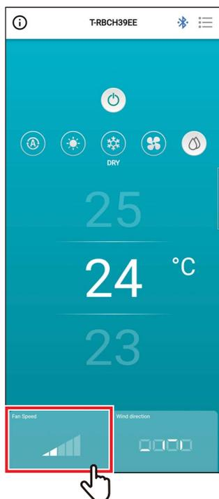
**2 Toque la velocidad del ventilador que desee ajustar**
