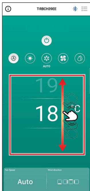
**1** Desplace el dedo por la pantalla hacia arriba o hacia abajo para seleccionar la temperatura que desea ajustar
